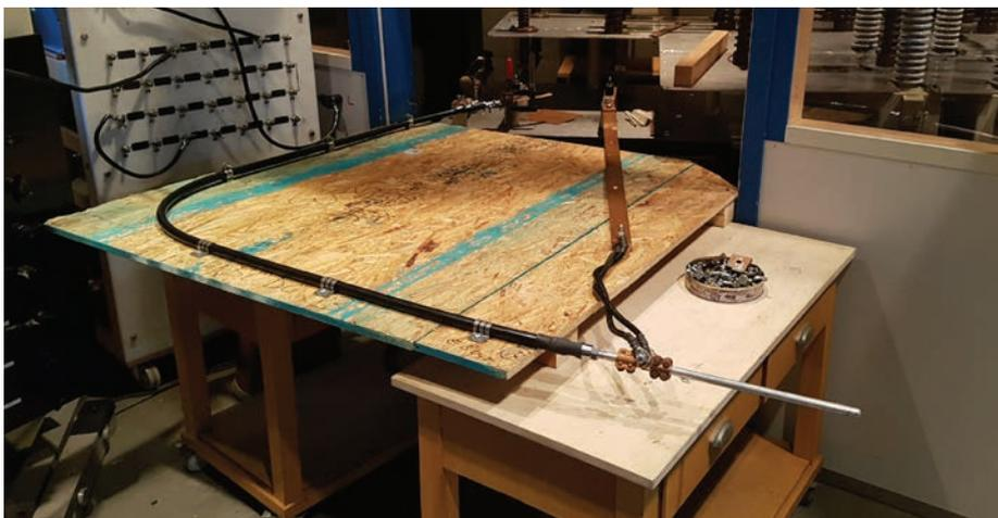
通过实验室测试，验证带连接器和紧固件的电缆的 200kA 10/350μs 额定值
