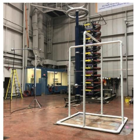
通过实验室测试验证等效分隔距离，包括电缆和独立式支撑杆
