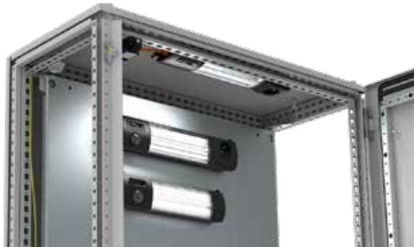
Las luminarias para gabinetes serie EL LED cuentan con una función de instalación rápida que permite su colocación en cualquier sector del patrón de orificios de 25 mm con el que están equipados los perfiles de los gabinetes nVent HOFFMAN. Las luminarias son fáciles de instalar, lo que reduce el tiempo de montaje; además, se pueden fijar al gabinete con tornillos o imanes.
