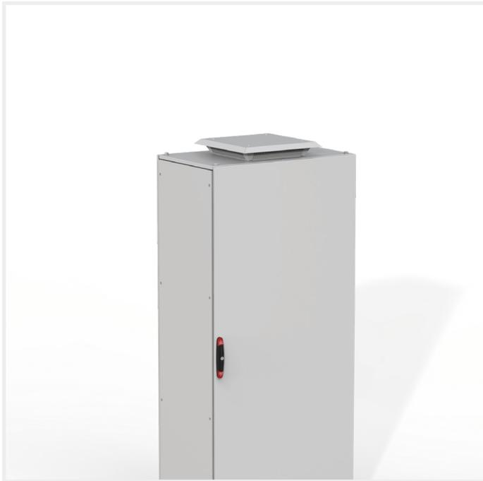
Esta salida de techo, REU, con grado de protección IP 33 o 54, es fácil de instalar gracias a su sistema de fijación rápida. Se trata de una buena solución cuando hay un espacio limitado en la puerta o en los paneles laterales del armario.
