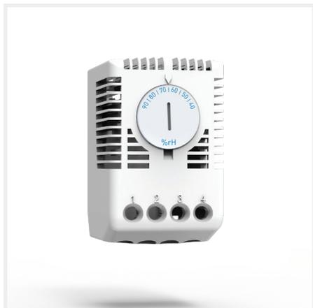
**Description:** Hygrostat mécanique conçu pour contrôler les résistances chauffantes lorsque le taux d'humidité relative prédéfini ou fixe est dépassé. Le taux d'humidité relative doit rester au-dessus du point de rosée pour éviter la condensation à l'intérieur de l'armoire. Clip de fixation pour rail DIN 35 mm (EN 60715).
