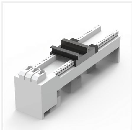
**Descrição:** Adaptador de barramento de 32 A. Com uma calha de montagem ajustável. Sem cabos, com terminais de mola de 1.5 - 6 mm<sup>2</sup>.
