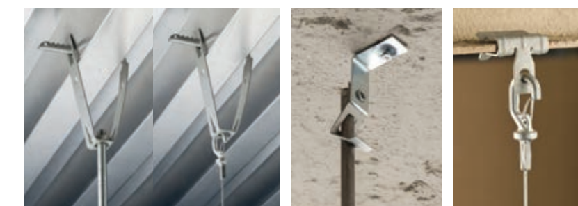
Gängad stång/kedja/vajer från trapetsformad ståltakfäste
