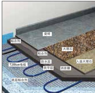
T2Blue-20 / T2BlueN-20 是用于地板采暖的恒功率发热电缆，输出功率约为  $18\text{W} / \text{m}$  (220V 时)。它是双导线发热电缆，且在发热电缆的一端有工厂预装 2.5 米长的冷端线。发热电缆应被安装于 15-50 mm 厚的混凝土找平层之中。
