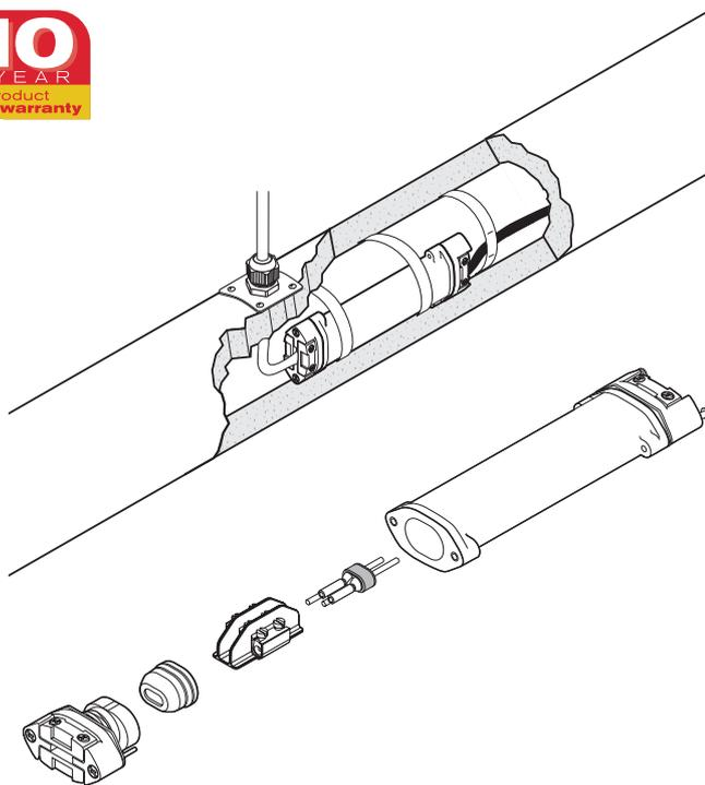
nVent RAYCHEM C-150-E ist eine Flachprofil-Anschluss-garnitur in Kaltanschlusstechnik für den direkten elektrischen Anschluss der Heizbänder vom Typ nVent RAYCHEM BTV, QTVR und XTVR, an ein flexibles Zuleitungskabel. Die Garnitur kann für Anwendungen im Temperaturbereich von  $-55^{\circ}\text{C}$  bis  $+200^{\circ}\text{C}$  eingesetzt werden und ist für die Verwendung im Ex-Bereich zugelassen.
