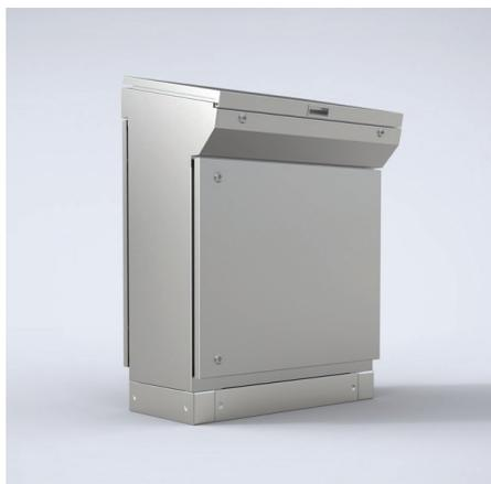
**Description:** Permet d'acheminer les câbles en toute liberté; conforme à la norme VDE 0113. Le socle se compose de quatre angles avec plaques amovibles. Deux hauteurs sont disponibles (100 et 200 mm); les plaques latérales sont amovibles.
