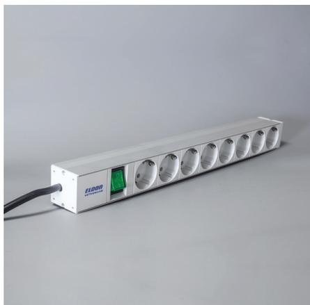
**Beschreibung:** Mit oder ohne AN/AUS-Schalter. Mit oder ohne Überspannungsschutz und Filter. Inkl. 2 m Kabel mit Winkelstecker. Inkl. 19"-Montagewinkel und Befestigungsmaterial. Die 19"-Montagewinkel können um 90° gedreht werden. Die Steckerbuchsen sind im 35° Winkel angebracht. Nickel beschichtete Erdungskontakte.
