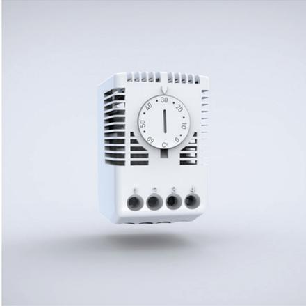
**Description:** Thermostat à contact inverseur pour gérer la température à l'intérieur des panneaux. Bilame thermostatique. Clip de fixation pour rail DIN 35 mm (EN 60715).
