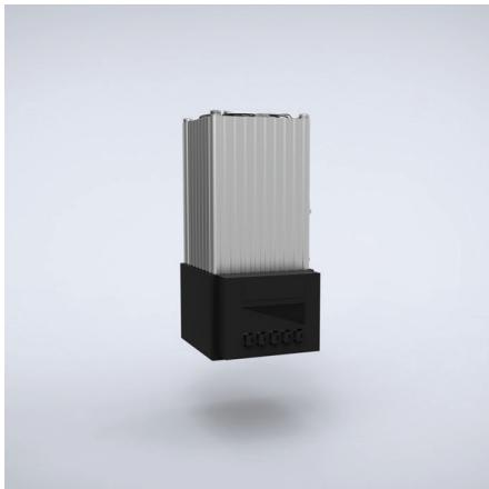
**Beskrivelse:** Varmeelement med blæser kan monteres som ønsket, men helst i lodret position for at forhindre kondens. Ventilatoren bistår den naturlige konvektion for hurtig distribution af varmen i større skabe. Monteringsclips til 35mm DIN-skinne (EN60715).
