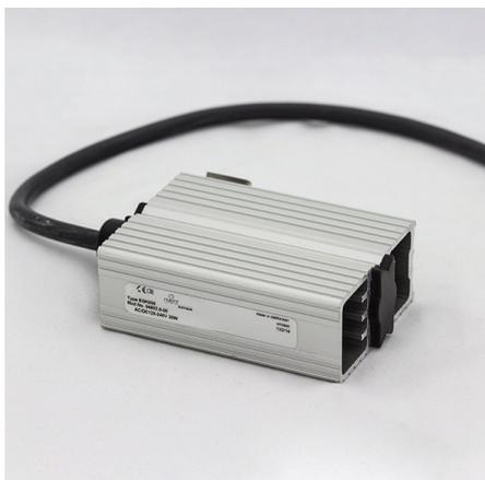
**Descrizione:** Piccolo riscaldatore a semiconduttore idoneo per montaggio in posizione verticale per prevenire la condensazione. Montaggio a scatto su binario DIN da 35 mm (EN60715). Per la versione UL, contattare nVent HOFFMAN.
