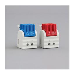
**Descripción:** Termostato para gestión de la temperatura. Sersor bimetal termostático. En color rojo (EFR202) con contacto normalmente cerrado para el control de calefactores. En color azul (EFR201) con contacto normalmente abierto para el control de dispositivos de refrigeración o señal. Montaje rápido sobre perfil DIN 35 mm (EN60715).
