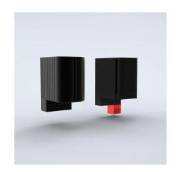
**Description:** Résistance chauffante verticale à double isolation pour éviter la condensation. Clip de fixation pour rail DIN 35 mm (EN 60715). Résistance chauffante anti-brûlure: les parties du boîtier accessibles restent froides pour éviter les brûlures. La résistance chauffante ECHT est équipée d'un thermostat, aucun câblage supplémentaire n'est donc nécessaire (démarre à 5 °C et se coupe à 15 °C).
