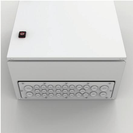
**Descrição:** Simples anilha fabricada em borracha. A instalação não requer ferramentas. O "pushout" membrana é um selo permanente até que seja perfurado por um cabo ou tubo. o IP é garantido. É equipado com uma "meia" que fecha em volta do cabo e permite que ele seja movido ao redor como um "joy-stick" na abertura, sem comprometer o IP, por isso funciona muito bem com os cabos passando por um ângulo. Apropriado para furos em materiais de 0,5 a 4,5 mm de espessura.
