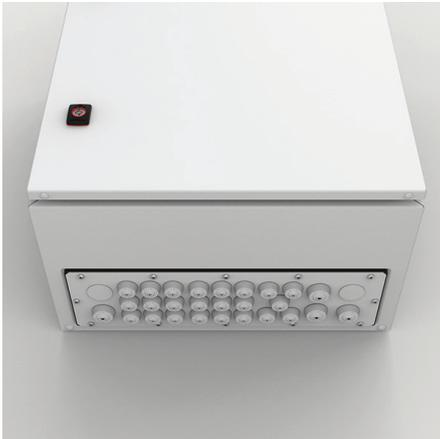
**Descrição:** Ilhó de dois componentes com o selo da membrana e ancoragem do cabo. A instalação não requer ferramentas, é auto-ajuste à sua espessura das paredes circundantes e clique com o botão fixo no lugar. Devido ao seu design compacto que se estende apenas 5.7 mm fora do recinto em que está montado. O "pushout" membrana é um selo permanente até que seja penetrado por um cabo ou um tubo. Apropriado para furos em materiais de 0.7 a 3 mm de espessura.
