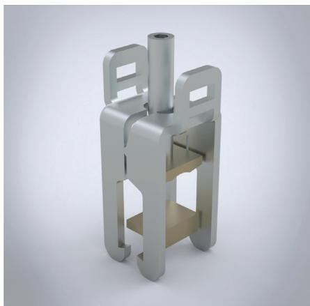
**Descrição:** Terminal de fixação, até 300 mm<sup>2</sup>, para condutores redondos. Terminal com parafusos de fixação cativos, condutor com possibilidade de sobreposição. Indicação da secção transversal nominal e do binário de aperto indicada no terminal.
