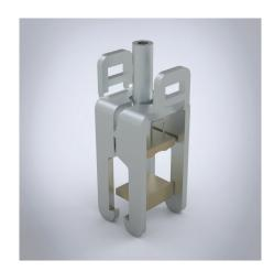
**Beschreibung:** Spreizklemme bis zu 300 mm², für Rundleiter. Spreizklemme mit unverlierbaren Klemmschrauben, Leiter kann übgreifen. Angabe des Nennquerschnitts und des Anzugsdrehmoments auf der Klemme.
