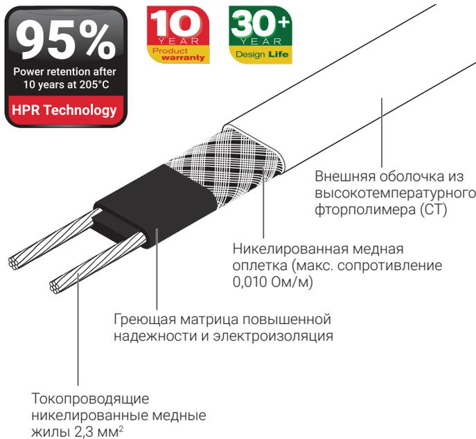
Саморегулируемый греющий кабель nVent RAYCHEM HTV предназначен для защиты от замерзания и поддержания технологической температуры трубопроводов и емкостей с высокой рабочей температурой (205°C)
