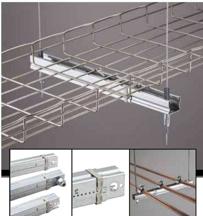
Il profilo Telescopico Strut è una innovativa alternativa all'utilizzo di profili strut tradizionali per installazioni a trapezio con accessori di montaggio strut standard. Questa soluzione telescopica elimina la necessità di movimentazione di lunghe barre di profilo da tagliare a misura. Il profilo si allunga sino alla lunghezza desiderata e si fissa in posizione semplicemente premendo una clip di bloccaggio elastica.
