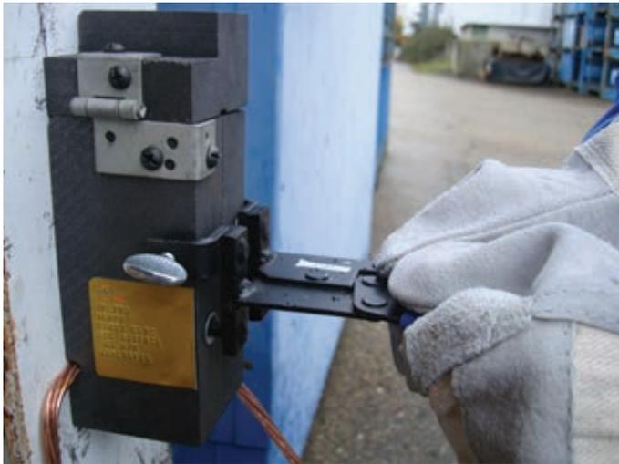
nVent ERICO Cadweld est une connexion électrique moléculaire permanente qui est insensible à la corrosion et est de très faible résistance : elle est tout simplement supérieure.
