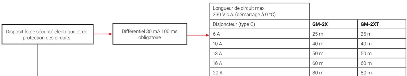
nVent TRACER les circuits chauffants en tenant compte de la longueur de circuit max. possible et de la puissance nécessaire pour la largeur de gouttière
