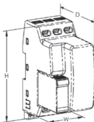
La familia de productos de filtrado de sobretensión transitoria (TSF) de nVent ERICO Critec es una solución homologada por UL, cumplimiento con IEC, compacta y de servicio para la protección de controladores PLC, sistemas SCADA, centros de control de motores y otros sistemas de control de procesos.
