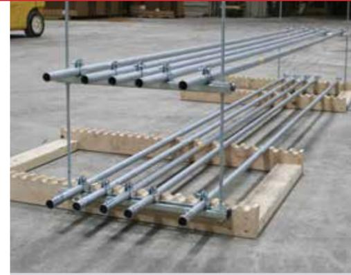
El espaciado de las tuberías en el soporte debe ser el mismo para que puedan conectarse fácilmente de extremo a extremo. Se recomienda el uso de plantillas de madera para garantizar un espaciado uniforme entre las tuberías y la repetibilidad de módulo a módulo. Este tipo de plantilla se puede hacer y personalizar rápidamente en el sitio o en el taller con piezas de madera.
