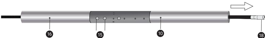
Figura 21: Pasar el conductor interior por el mástil
