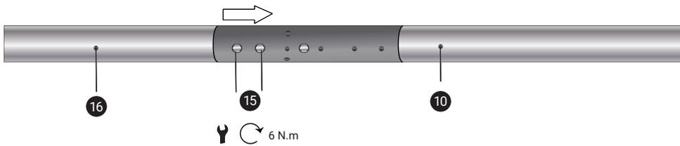
Figura 19: Unión de las piezas superiores e inferiores del mástil
