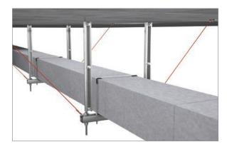
Los estándares internacionales aceptan el uso de arriostramientos por cable y materiales rígidos. El arriostramiento por cable tiene las ventajas de ser versátil, ligero y fácilmente transportable.
