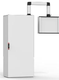
Der Bedienerschnittstellen-Schalschrank OICE aus Stahlblech hat ein vorgearbeitetes Lochmuster zur Befestigung eines Schwenkarms sowie eine abnehmbare Frontplatte mit Schutzart IP 55. Die Komponenten können dank der abnehmbaren Frontplatte leicht montiert werden, sind aber auch über eine rückwärtige Tür leicht zugänglich. Seitengriffe am Schalschrank ermöglichen das einfache Bewegen des Schrankes in die Arbeitsposition.
