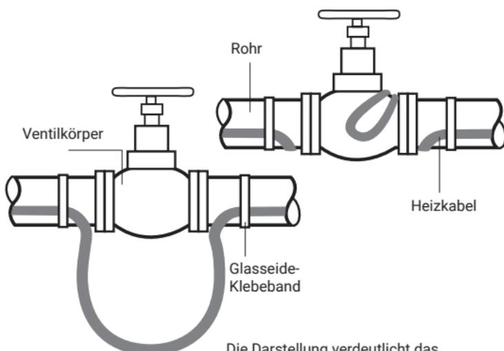
Die Darstellung verdeutlicht das allgemeine Installationsverfahren. Die Heizkabelverlegung kann je nach Ventil-Art und Heizkabeltyp variieren.
