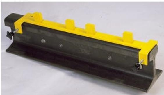
**9.1.3 Zuordnung von speziellen Profilschablonen mit Sonderbohrhöhen zu den jeweiligen Abstandslehren mit Bohrerführung für Achszähler bzw. Radsensoren von Siemens, SEL und Tiefenbach/Frauscher**
