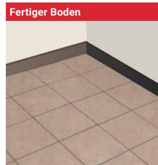
Dichten Sie zwischen den Fliesen und den Wänden mit Silikondichtmittel ab. Lassen Sie den Fußboden vollständig aushärten, bevor Sie das Fußbodenbeheizungssystem einschalten.
