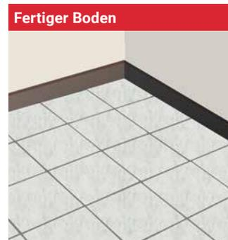
Dichten Sie zwischen dem Naturstein und den Wänden mit Silikondichtmittel ab. Lassen Sie den Fußboden vollständig aushärten, bevor Sie das Fußbodenbeheizungssystem einschalten.
